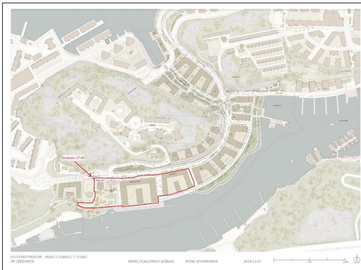
Figur 1.1: Illustrationsplan av den planerade utbyggnaden i stadsbyggnadsprojektet Gäddviken med den befintliga fastighetsgränsen och den nya fastighetsgränsen och uppdelningen av kvartersmark och allmänna platsmarken på platsen.
